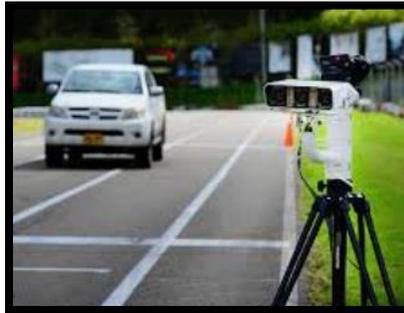
**De radar en el camino (ATR):** opera en un ángulo específico en la trayectoria del vehículo y que le permite generar el efecto del ángulo coseno.
